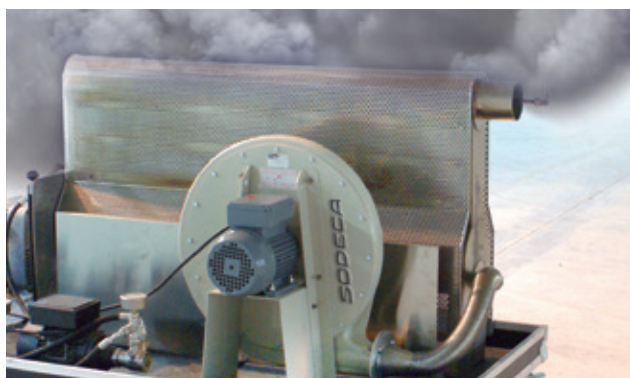
Генератор дыма для осуществления реальных дымовых испытаний
